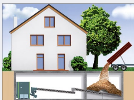
Transport du combustible à partir du silo de stockage situé à distance grâce à une deuxième vis d'alimentation
