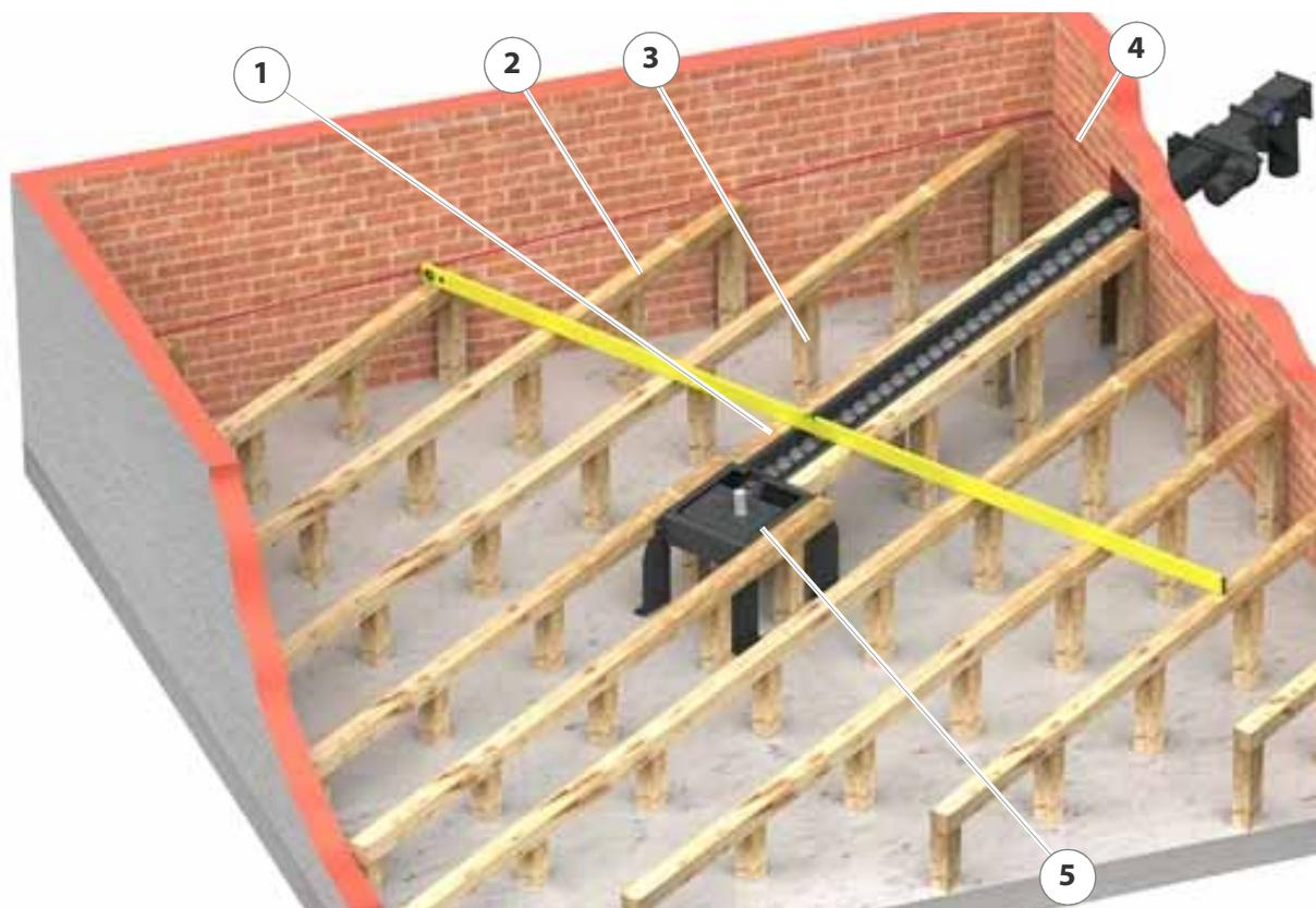
Figure 4/22 - Construction inférieure (canal fermé **pas** à 90° par rapport au mur)
