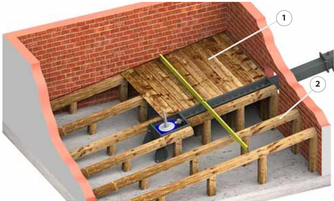
Figure 4/23 - Montage du plancher intermédiaire
