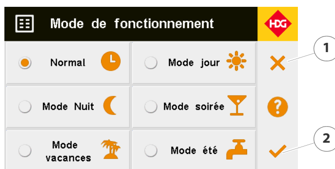
Figure 5/28 - Mode de fonctionnement circuits de chauffage
