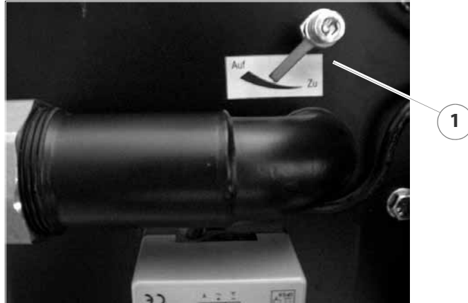
Figure 4/14 - Réglage du tube d'équilibrage de la pression
