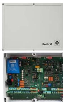
Le EM8+4 est la combinaison des modules EM8 et EM4. Il est équipé de 12 entrées de sonde et de possibilités de raccordement pour trois mélangeurs (ou vannes d'inversion) et cinq pompes de circulation. Il est ainsi possible de raccorder jusqu'à 3 circuits de chauffage à régulation climatique et 2 ballon d'eau chaude sanitaire. Ce module est livré comme module d'extension externe, prémonté dans un boîtier mural.
