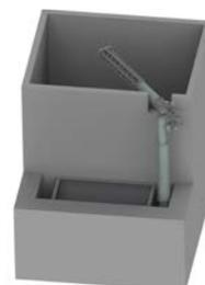
Illustration : auge de remplissage dans le sol, vis montante (2 m de base + 2 m de prolongation), vis de remplissage (2 m de base + 2 m de prolongation)
