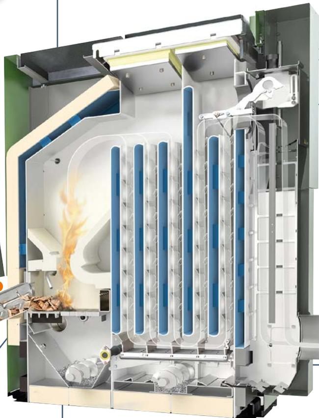
Sur le modèle HDG Compact 30-149E, l'électrofiltre intégré garantit des émissions de poussières au plus bas de façon durable sur tout le cycle de fonctionnement de la chaudière, de l'allumage à l'extinction. Toutes les particules fines sont capturées et envoyées vers le cendrier de manière automatique dans le cendrier extérieur, comme les cendres du foyer et les suies.
