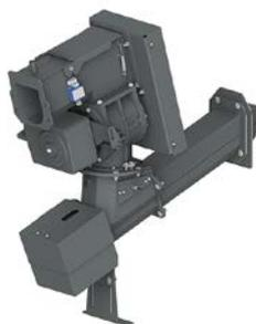
Le nouveau chargeur HDG Vario VBZ 120 est constitué de la tête de désilage, de la vanne écluse et du chargeur 120. Le combustible est extrait du silo est conduit via le canal fermé jusqu'à la tête de désilage. Il est alors transféré dans la vanne écluse à 4 chambres de diamètre 250 mm. Celle ci sert d'organe de sécurité pour rendre étanche la liaison entre la chambre de combustion et le silo. La connexion directe entre la tête de désilage et la vanne écluse permet un
