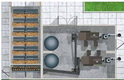
Le fond mouvant est disponible avec jusqu'à trois verrins d'extraction. Selon le modèle, il est possible d'assurer l'extraction du combustible de l'espace de stockage jusqu'à 75m<sup>2</sup> et 4m de haut. Le fond mouvant est particulièrement adapté aux installations de grande puissance ayant une forte consommation de combustible.
