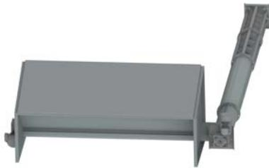
Illustration : auge de remplissage avec couvercle, vis de remplissage (2 m de base)
