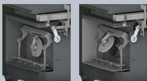
Volet des gaz de combustion fermé
