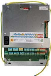
Le module EM8 chaudière est équipé de 8 entrées de sonde et de possibilités de raccordement pour deux mélangeurs (ou vannes d'inversion) et trois pompes de circulation. Il est ainsi possible de raccorder jusqu'à 2 circuits de chauffage à régulation climatique et 1 ballon d'eau chaude sanitaire. Ce module est conçu pour être monté directement dans la chaudière HDG K10-33 V2.
