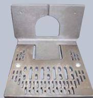
La grille de combustion en fonte grise, massive, refroidie par air, alimentée directement par le chargeur, ainsi que la chambre de combustion haute température éprouvée, assurent une puissance homogène. Les réfractaires en béton réfractaire sont modulables et peuvent être démontés facilement. Les résidus de combustion sont vidés dans le cendrier par basculement de l'assiette de manière fiable.
