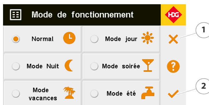
Figure 5/28 - Mode de fonctionnement circuits de chauffage
