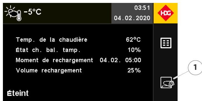
Figure 8/2 - Mise en marche de l'installation de chauffe
