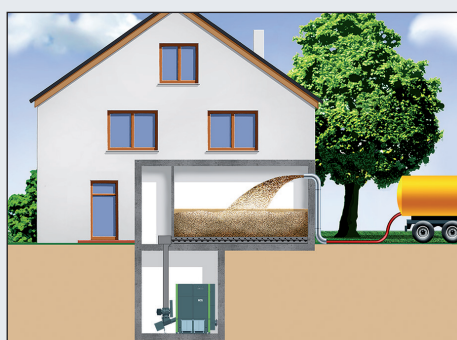
Silo de stockage éloigné de la chaufferie, transport des granulés par vis de transfert et gravitaire
