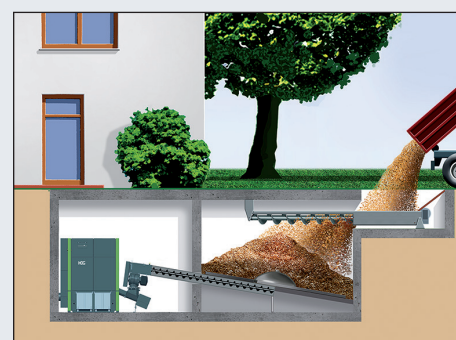
Silo de stockage à la cave avec vis de transfert pour le remplissage par le soupirail
