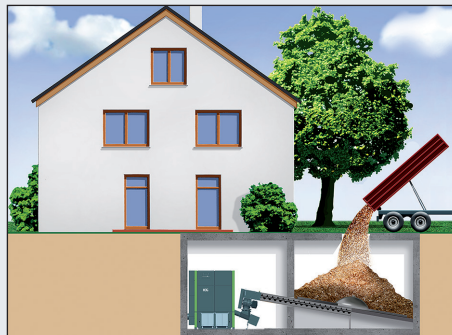
Silo de stockage souterrain avec trappe supportant le passage de véhicules
